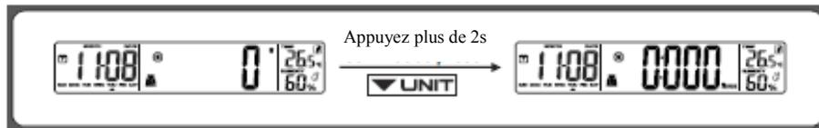
**Note :** si vous n'appuyez que brièvement sur la touche « Unit », vous entrez dans le mode « Volume d'eau » puis « Volume de lait ». Une pression longue est nécessaire pour changer le système de mesure. Par défaut, la balance est programmée sur le mode impérial.
